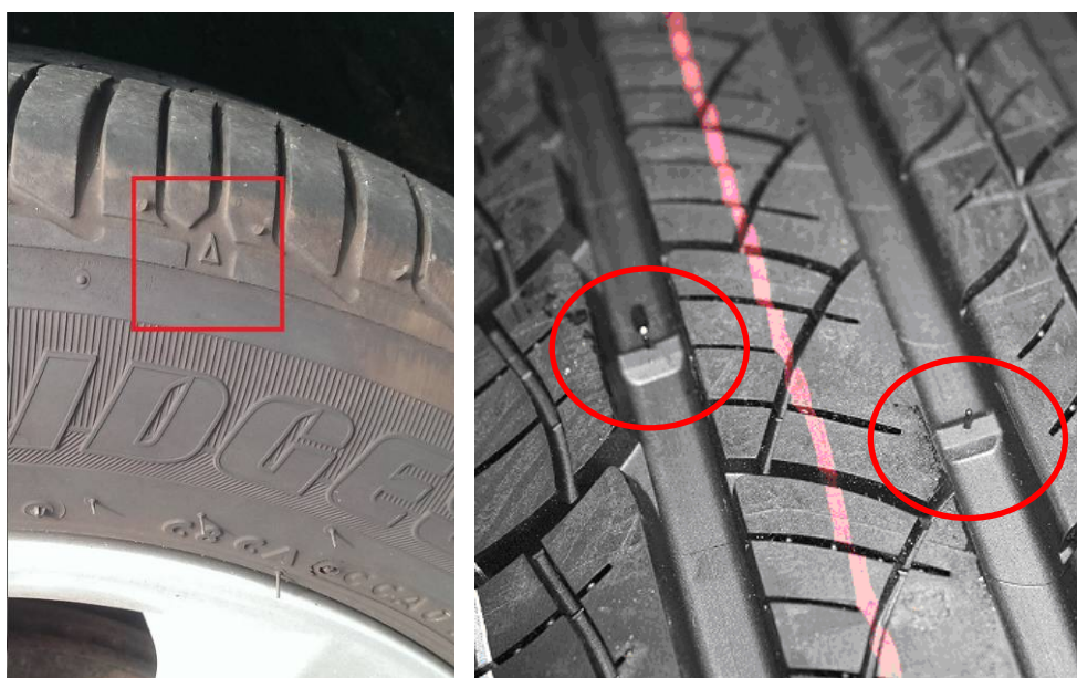
圖 5 輪胎磨耗指示示意圖
