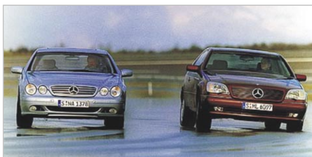
圖1. 車輛因轉彎產生車體翻滾現象 (右車:傳統懸吊, 左車:主動式懸吊)[1]
