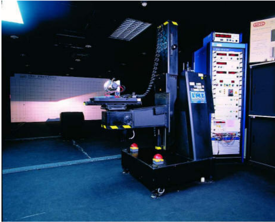
圖2：歐規汽車頭燈光型圖
