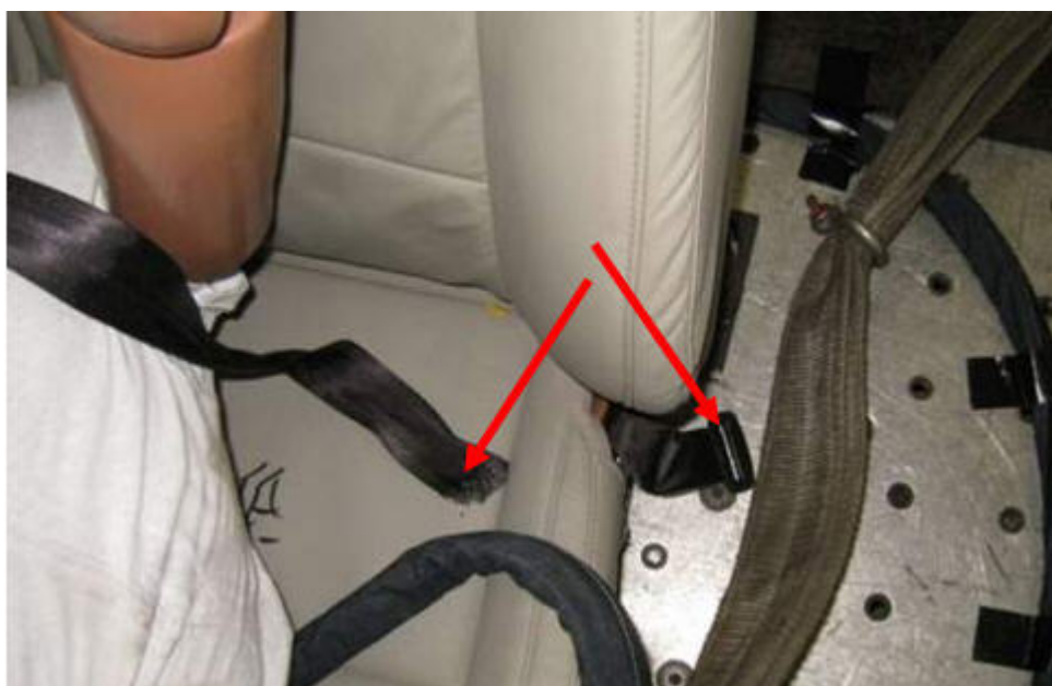
圖 2：人偶安全帶僅繫肩帶測試後狀況－安全帶織帶被舌片環磨斷
