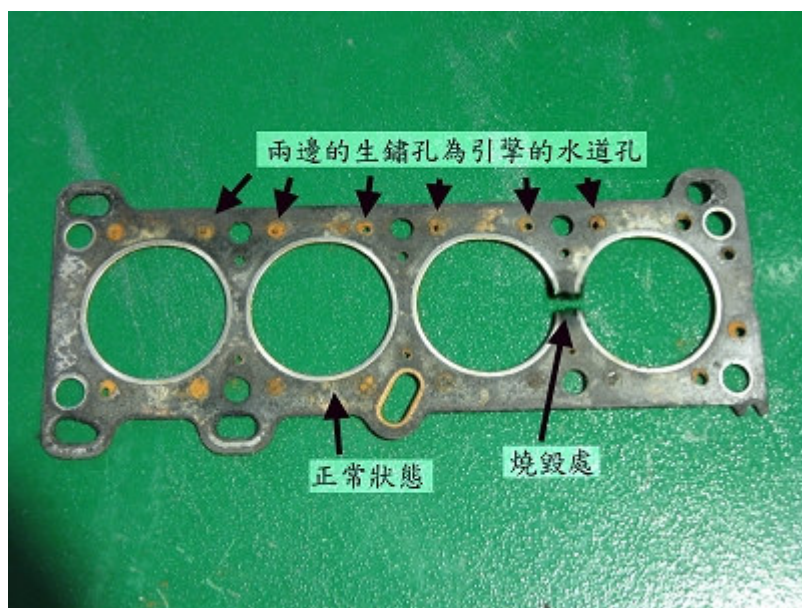
圖 5、汽缸床墊片已燒毀
