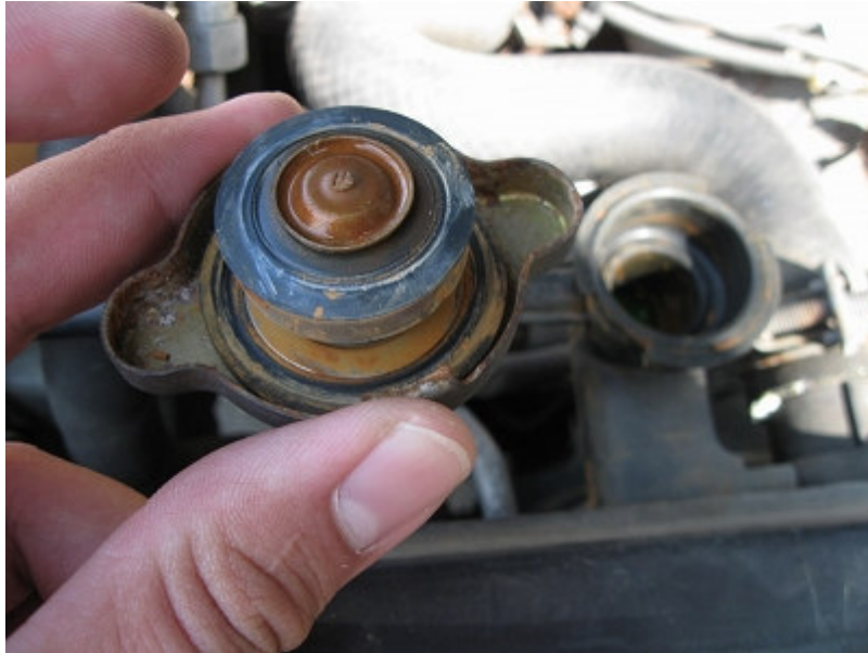
圖 3、水箱蓋完全開啓（水箱蓋為 2 段式開啓，開啓前，請確認冷引擎狀態）
