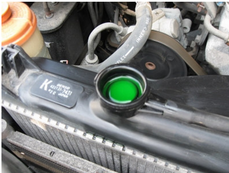
圖 4、引擎溫度完全冷卻時發動，水箱水位因引擎振動，但靜置不會冒氣泡（正常狀態）
