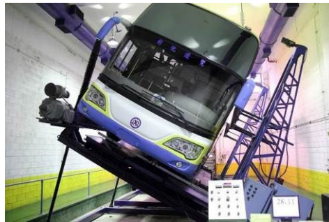
圖 4、大客車傾斜穩定度測試情形
