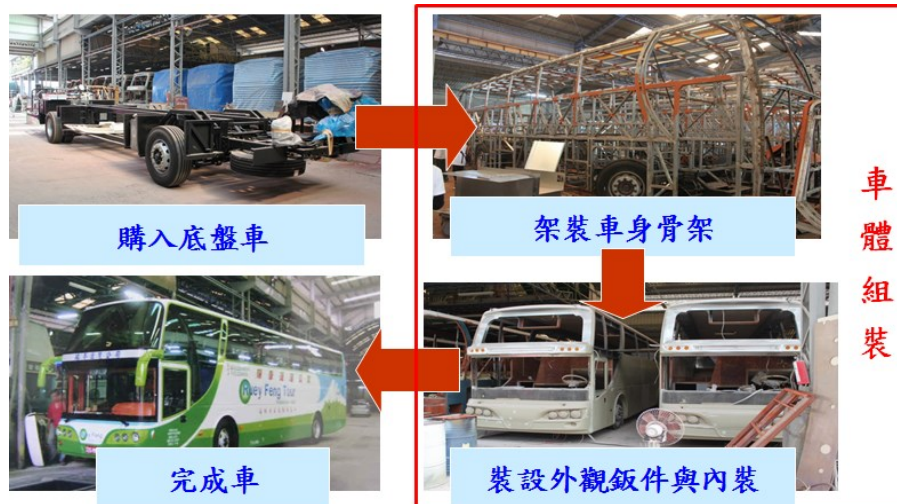
圖 1、國內多數採底盤組裝車體之大客車生產流程(圖片來源： http://library.taiwanschoolnet.org/cyberfair2011/dqesgo/rpt2.htm )
