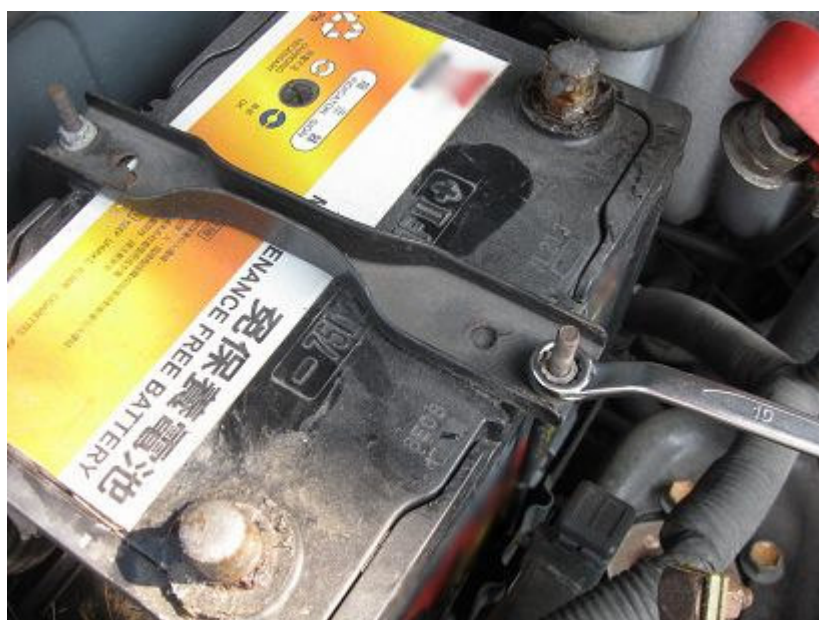
圖 6 拆下電瓶固定架的螺絲
