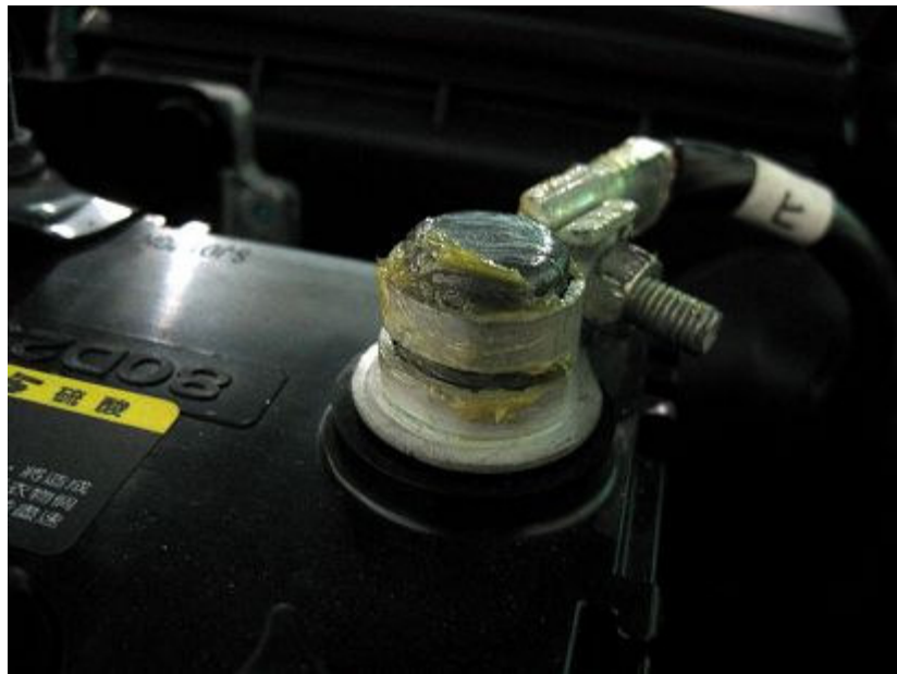
圖 11 接線處塗抹油脂保護
