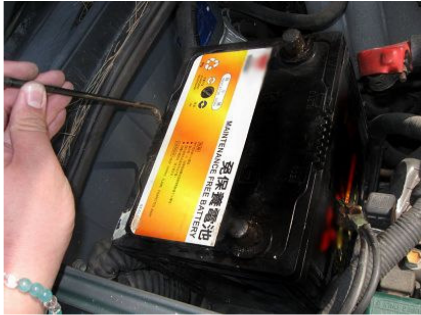
圖 10 可先勾住內側的固定架，會比較容易安裝
