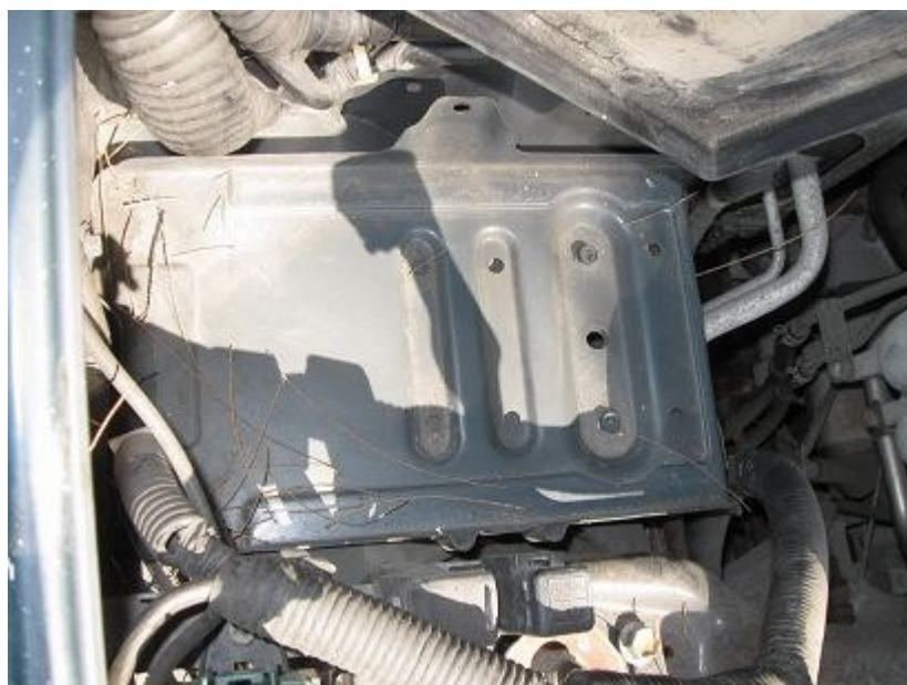
圖 9 塑膠托盤下的金屬件，記得清潔上些油脂
