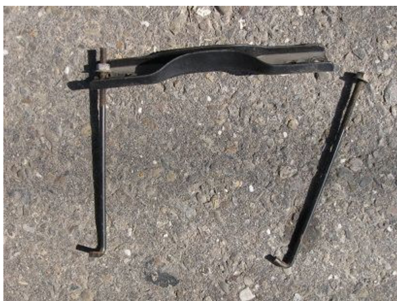
圖 6 拆下電瓶固定架的螺絲
