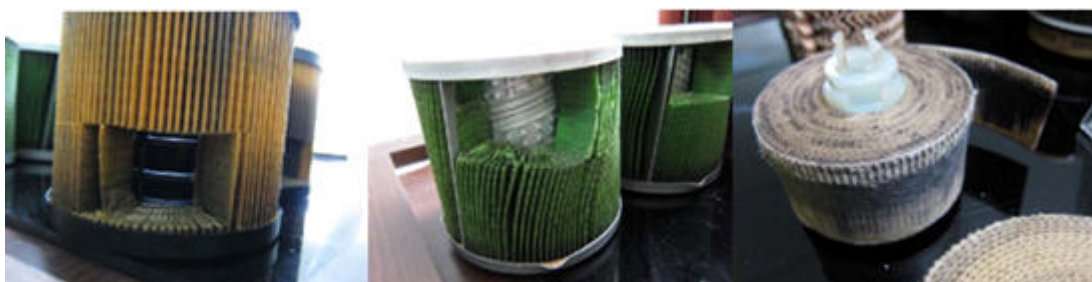
圖一 濾清器內部構造示意圖
