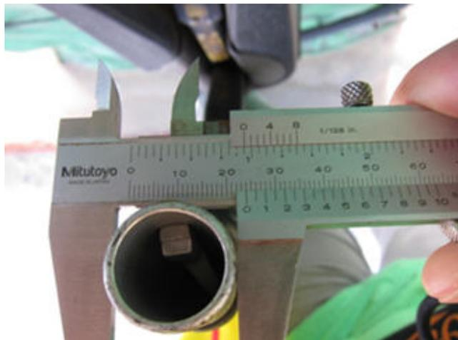
圖 2 柴油加油槍外徑量測，約 2.4 公分
