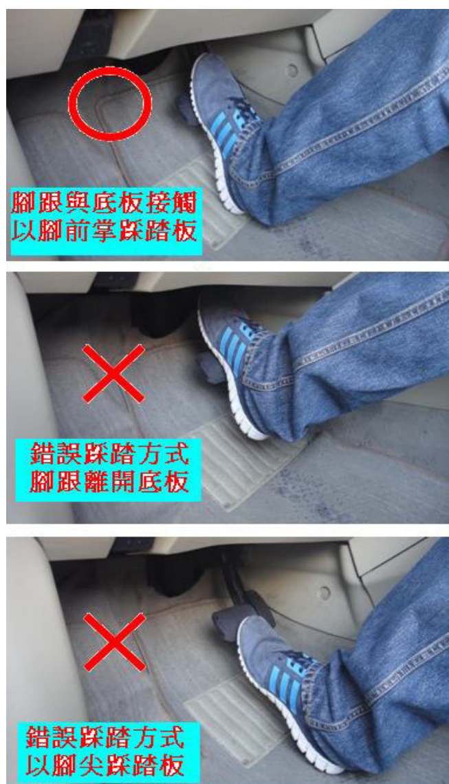
圖 1 正確踩踏煞車踏板
