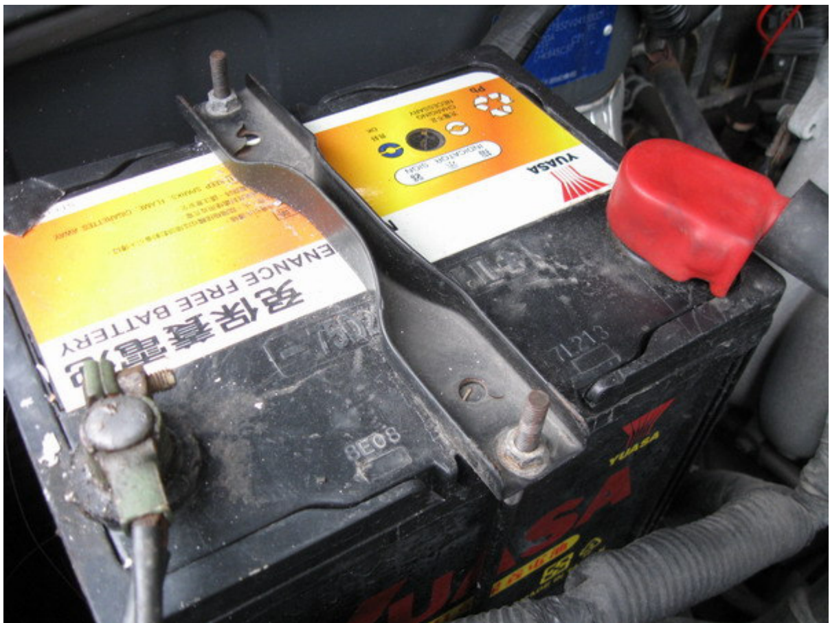
圖 4、一定要確認電瓶有固定、絕緣
