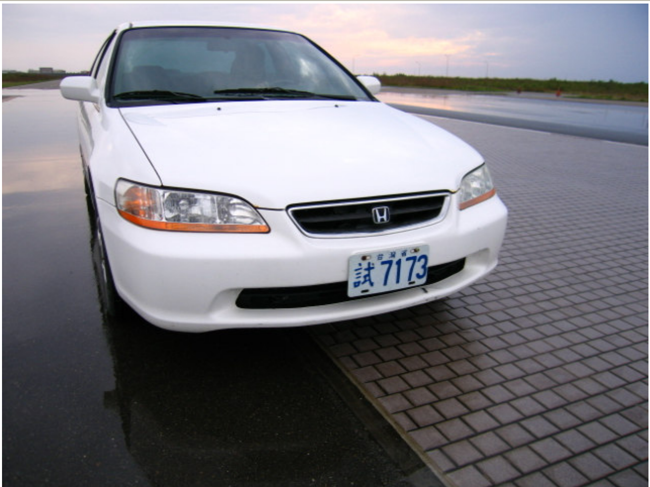
圖片 1 ABS 系統測試-分隔路面測試
