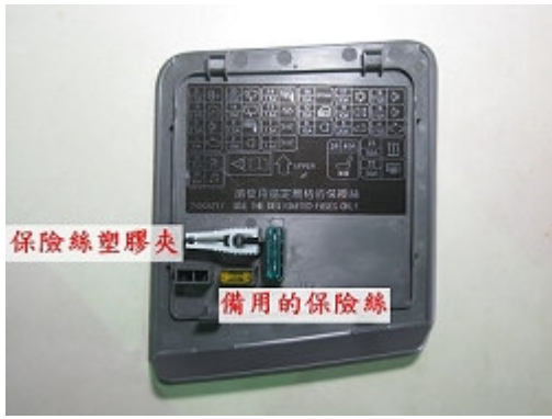
圖 7 使用保險絲塑膠夾，將保險絲垂直拉出
