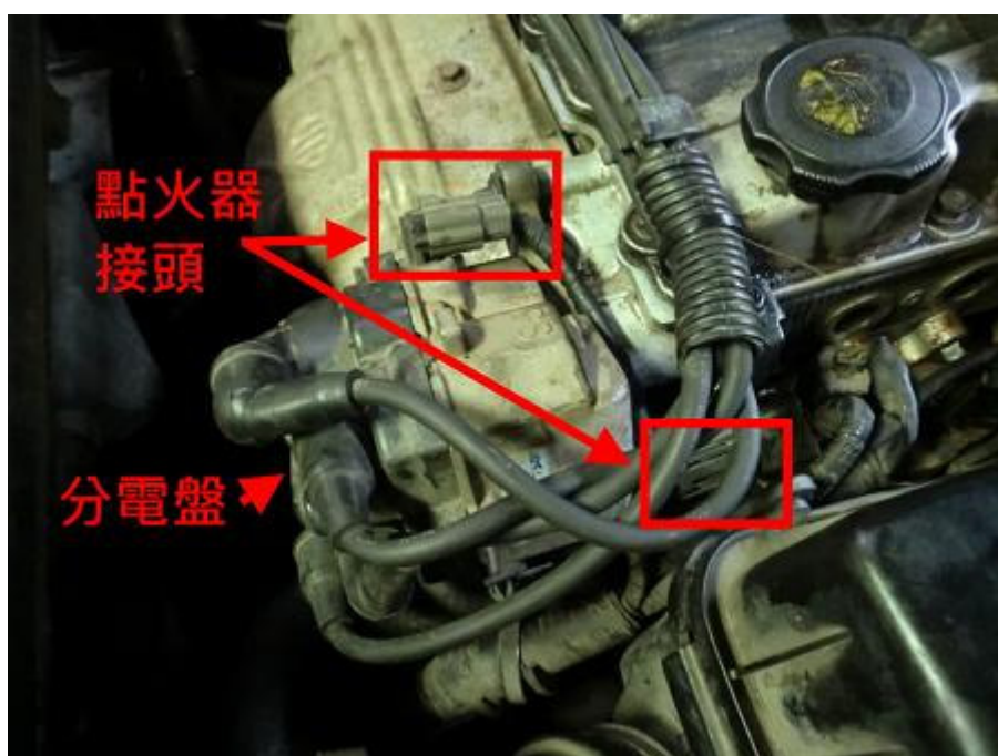
圖 6 鬆脫、拔離任一個點火器接頭即可
