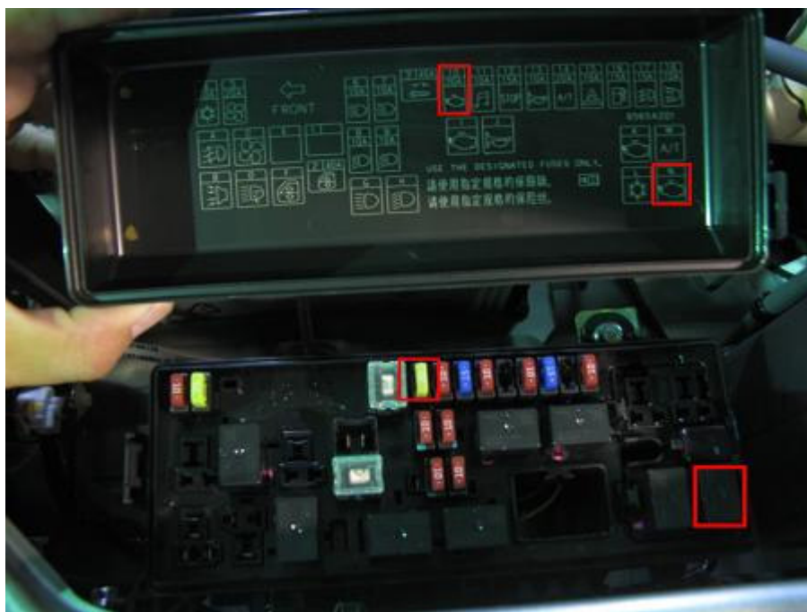
圖 5 取下引擎圖樣的保險絲或繼電器
