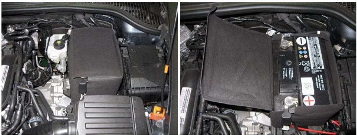
圖 5、原廠設計將電瓶完整包覆
