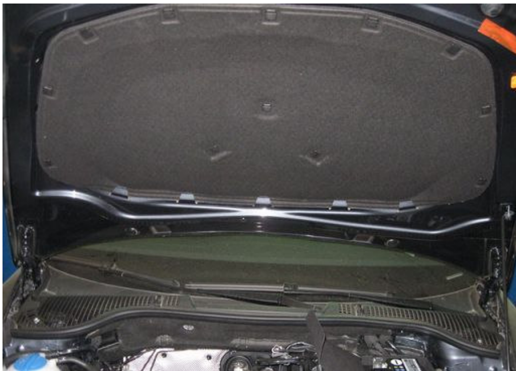
圖 6、引擎蓋上隔音、隔熱、絕緣材質的墊片
