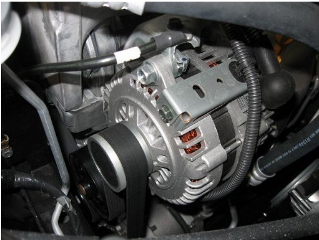
圖 2、引擎皮帶帶動發電機發電
