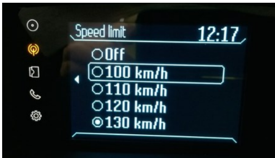
圖三、Ford MyKey 系統中之車速限制調整功能示意圖。資料來源：網路。網址： http://www.caradvice.com.au/312873/ford-mykey-expands-with-lower-speed-limit-settin gs/
