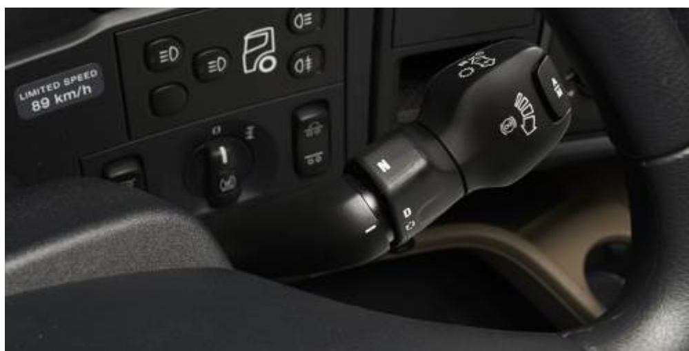
圖二、SCANIA 大貨車上所裝設之不可調式車速限制機能。
