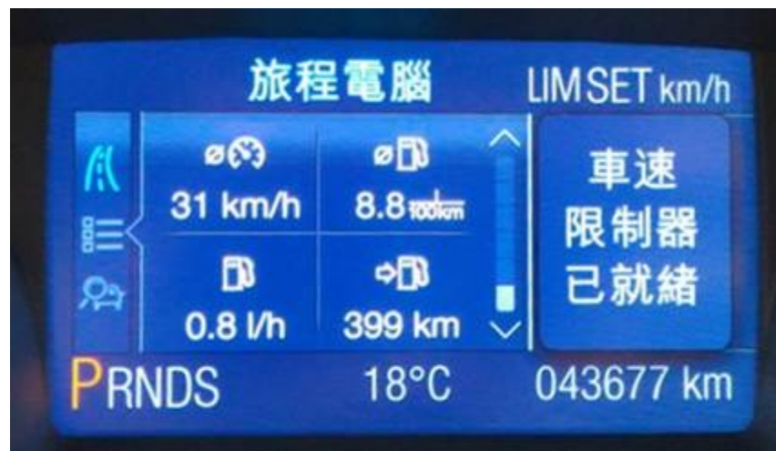
圖四、車速限制機能作動示意圖
