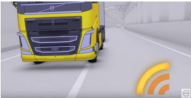
圖 4 VOLVO Trucks 所運用之 LDWS 車道偏離輔助警示系統
