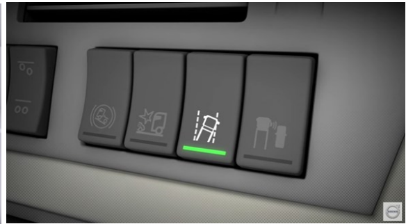
圖 4 VOLVO Trucks 所運用之 LDWS 車道偏離輔助警示系統
