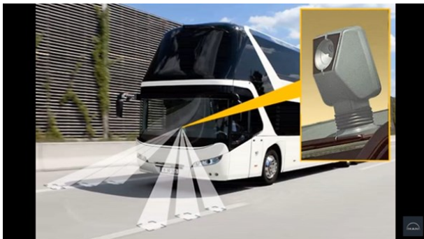
圖 6 MAN BUS 所運用之 LDWS 車道偏離輔助警示系統
