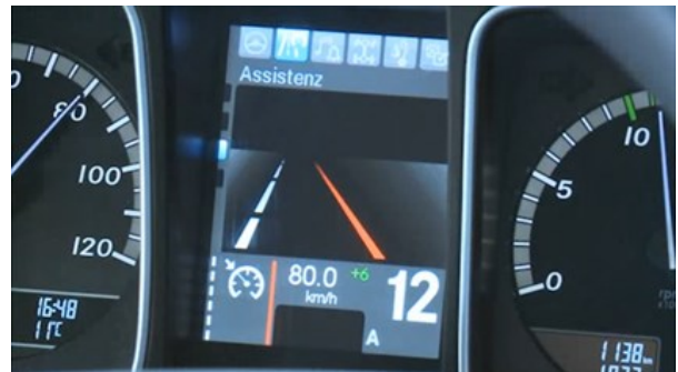
圖 5 Mercedes-Benz Trucks 所運用之 LDWS 車道偏離輔助警示系統
