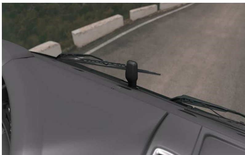
圖 3 SCANIA 利用裝在擋風玻璃上之攝影機感測路面
