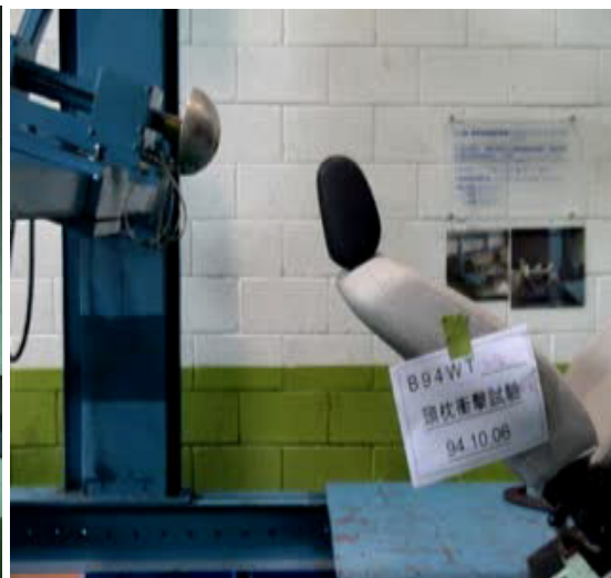
圖 3 頭枕後表面衝擊試驗
