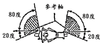
圖二 微型電動二輪車方向燈水平方向之照射角度要求
