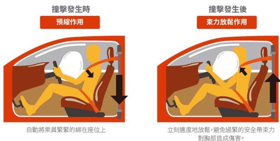
圖九、具預負載裝置之車用安全帶與拉力限制器搭配效果
