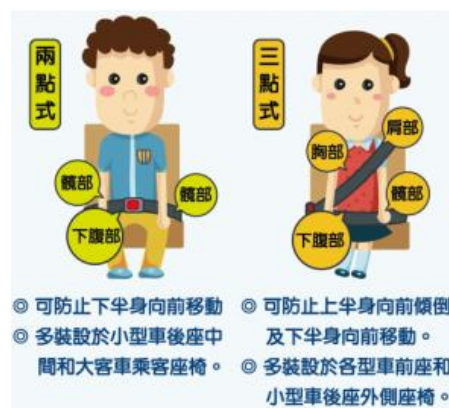
圖二、車用安全帶固定點示意圖
