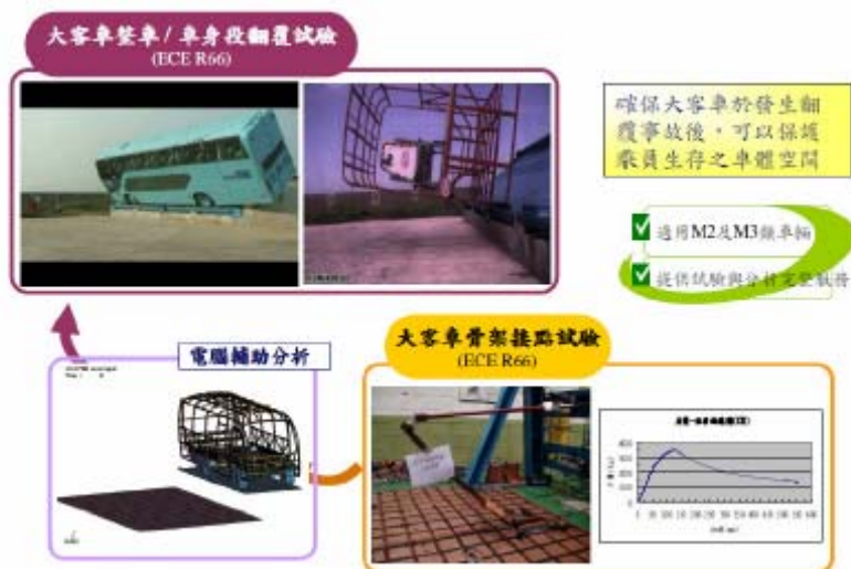
圖 3 大客車車身結構強度各項檢測與分析驗證流程
