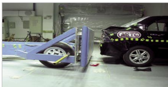
圖2.11：後方(歐規台車)碰撞檢測實例
