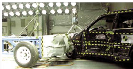
圖2.10：側方(歐規台車)碰撞檢測實例
