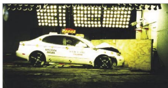
圖2.14：角度(30度)前方碰撞檢測實例
