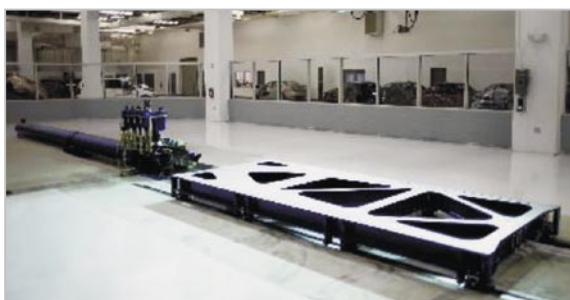
圖2.3：伺服加速模擬測試設備配置
