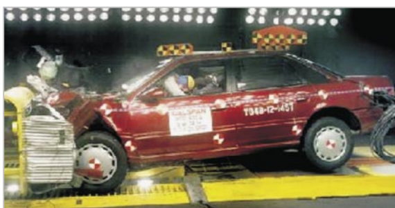
圖2.5：碰撞主系統(前方偏置碰撞實例)
